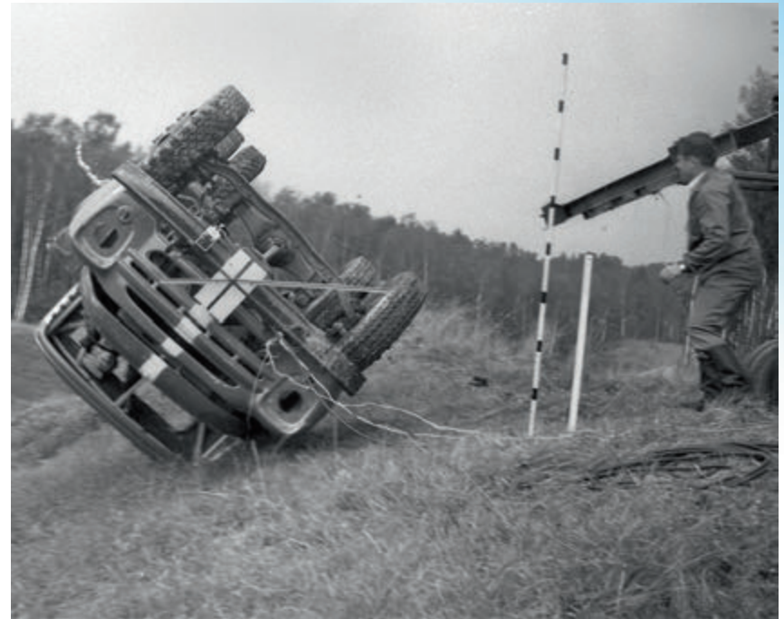
Поперечное опрокидывание грузовика ЗИЛ-130
