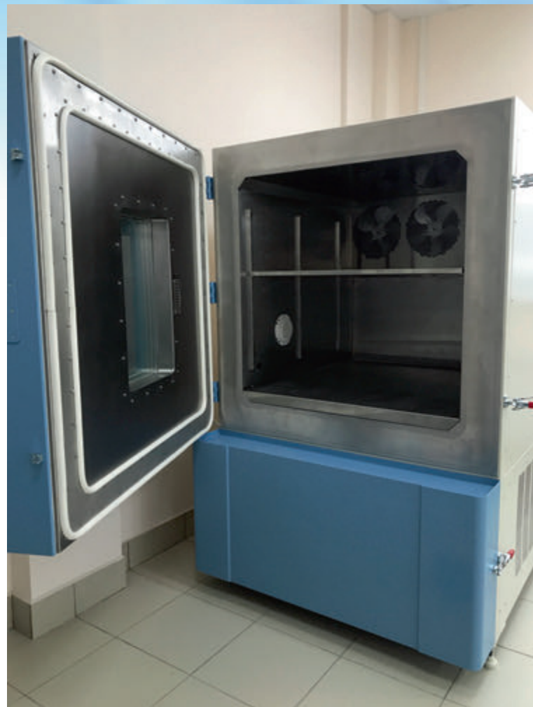
Климатическая камера для кондиционирования образцов
