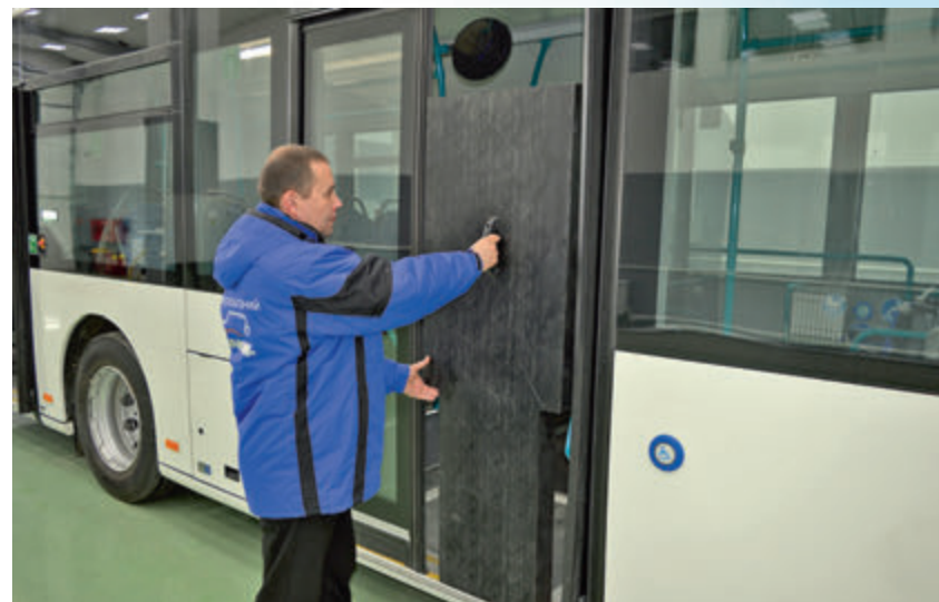
Контрольный шаблон для проверки доступа к служебным и запасным дверям
