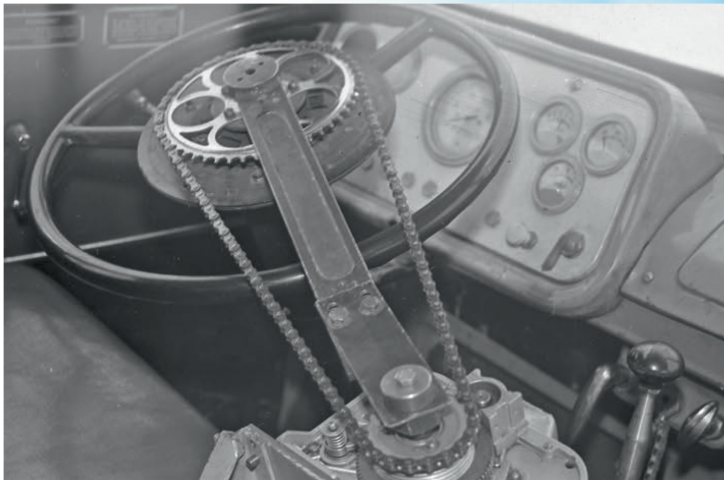
Устройство рулевого управления на автомобилях при реализации автоматического вождения
