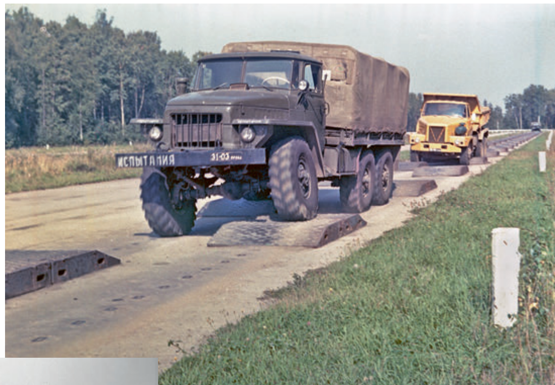
Испытания самосвала ЗИЛ-ММЗ-554 на треке со сменными неровностями
