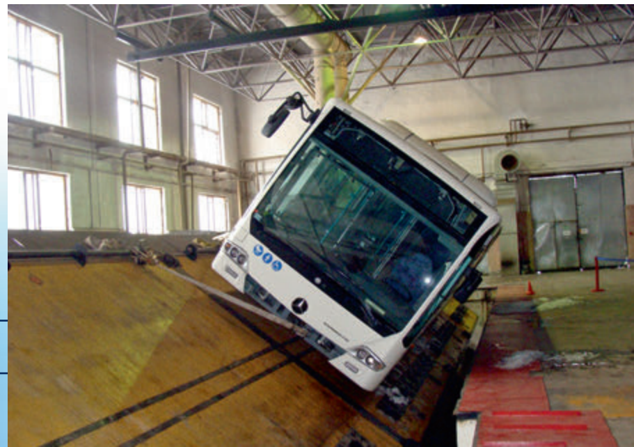
Испытания автомобиля, оснащенного системой вызова экстренных оперативных служб, методом динамического опрокидывания
