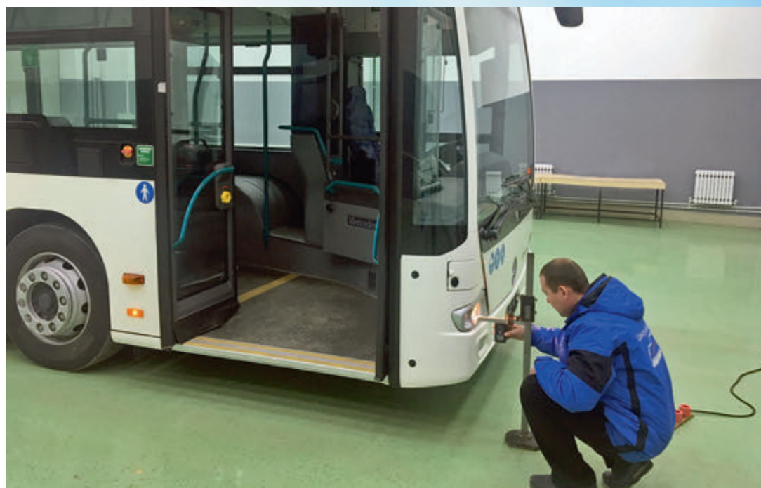
Проверка размещения фар ближнего света по высоте на автобусе Mercedes-Benz Conecto
