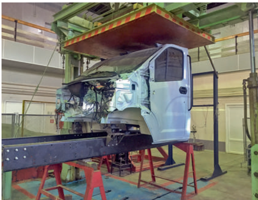
Статические испытания прочности крыши кабины грузового автомобиля
