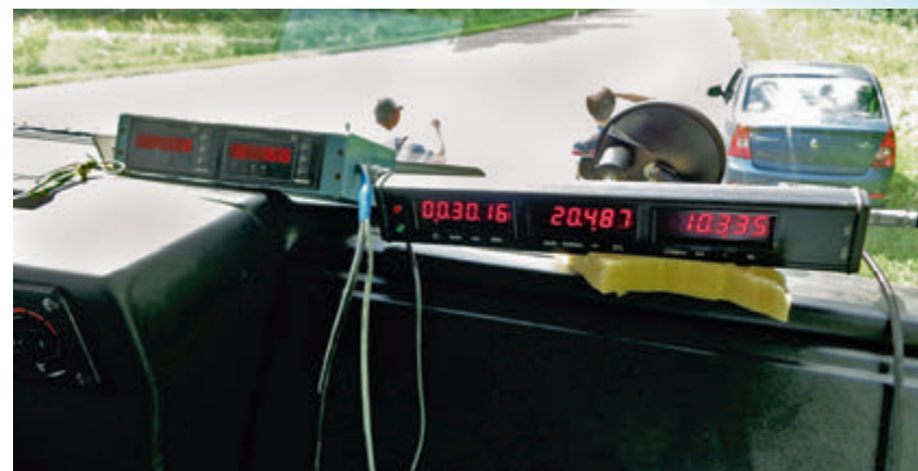
Регистрирующий прибор к счетчикам расхода топлива
