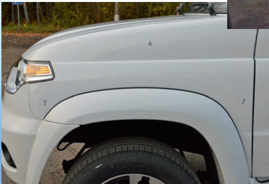
Подготовка кузова к испытаниям на коррозионную стойкость
