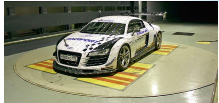
Аэродинамические испытания автомобиля для шоссейно-кольцевых гонок Audi R8
