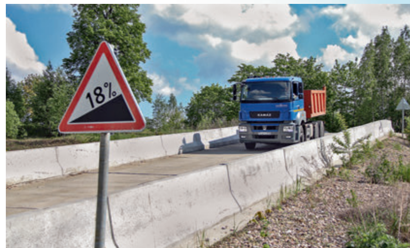
Испытания стояночной тормозной системы на подъеме
