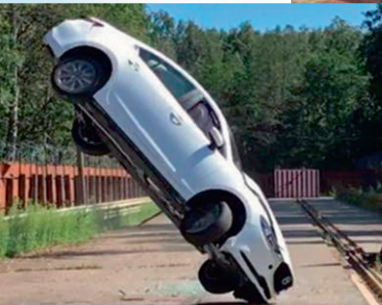
Испытания автомобиля, оснащенного системой вызова экстренных оперативных служб, методом динамического опрокидывания
