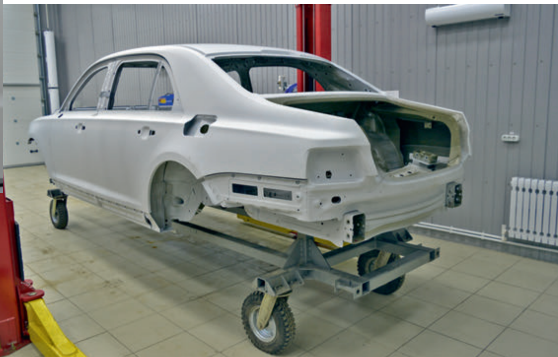
Нанесение искусственных очагов коррозии (ИОК) перед началом испытаний
