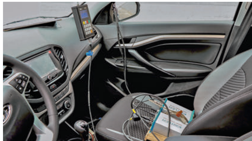
Система сбора и обработки информации CDS Logger
