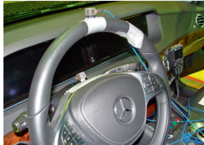
Измерение локальной вибрации на руле
