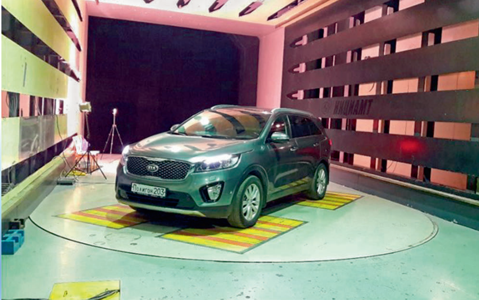
Испытания в аэродинамической камере по оценке влияния параметров окружающей среды на содержание вредных веществ в воздухе салона автомобиля
