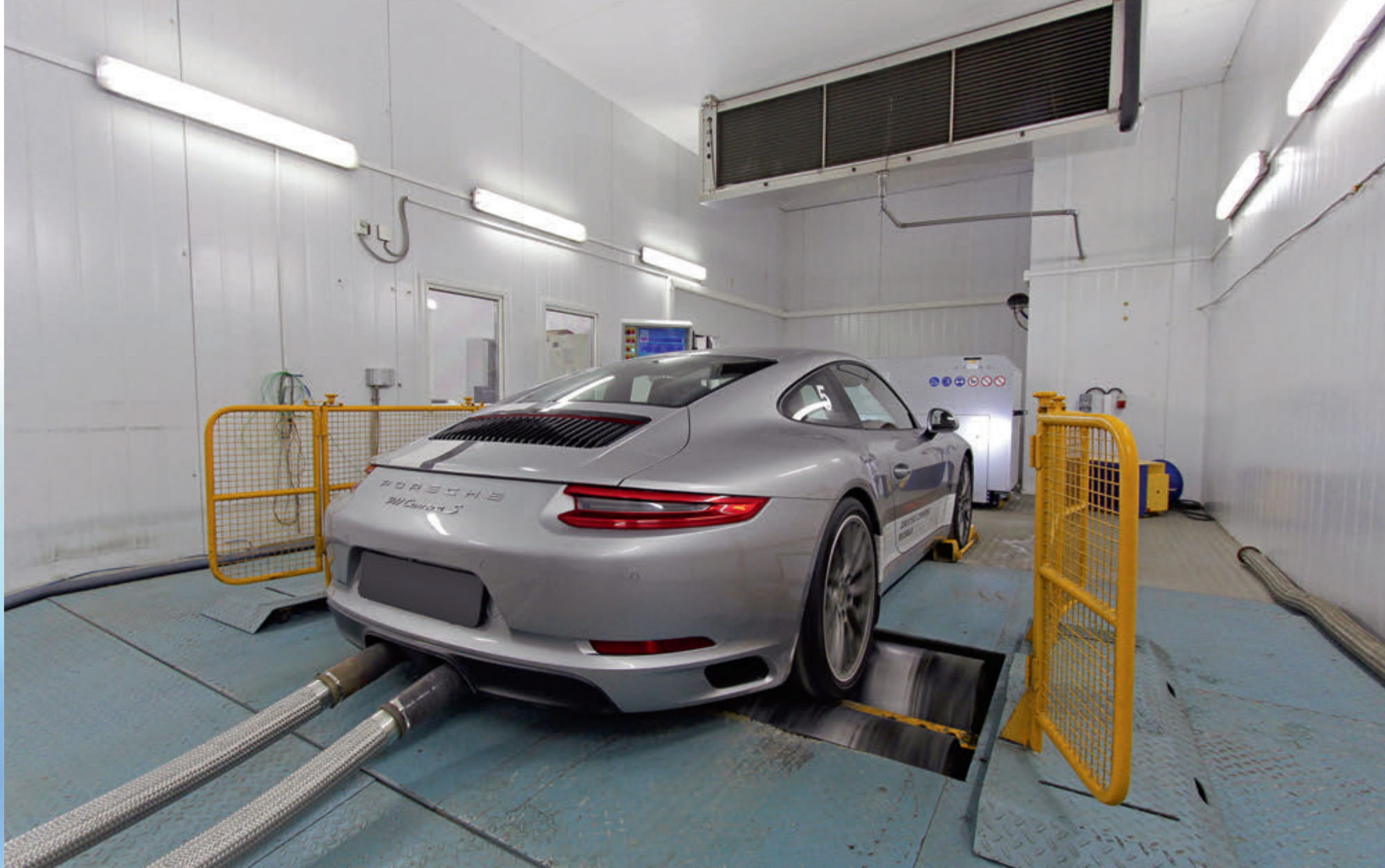
Испытания по определению влияния бензина АИ-100-К5 на экологические и экономические характеристики легкового автомобиля спортивного типа
