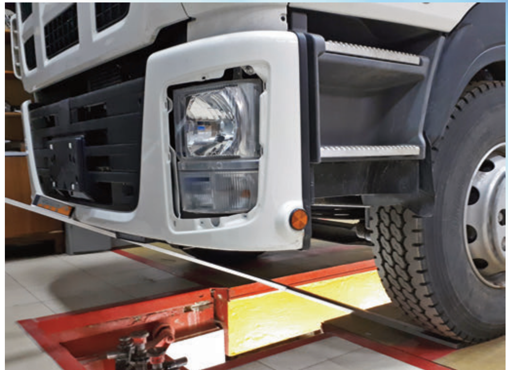
Определение параметров геометрической проходимости автомобилей
