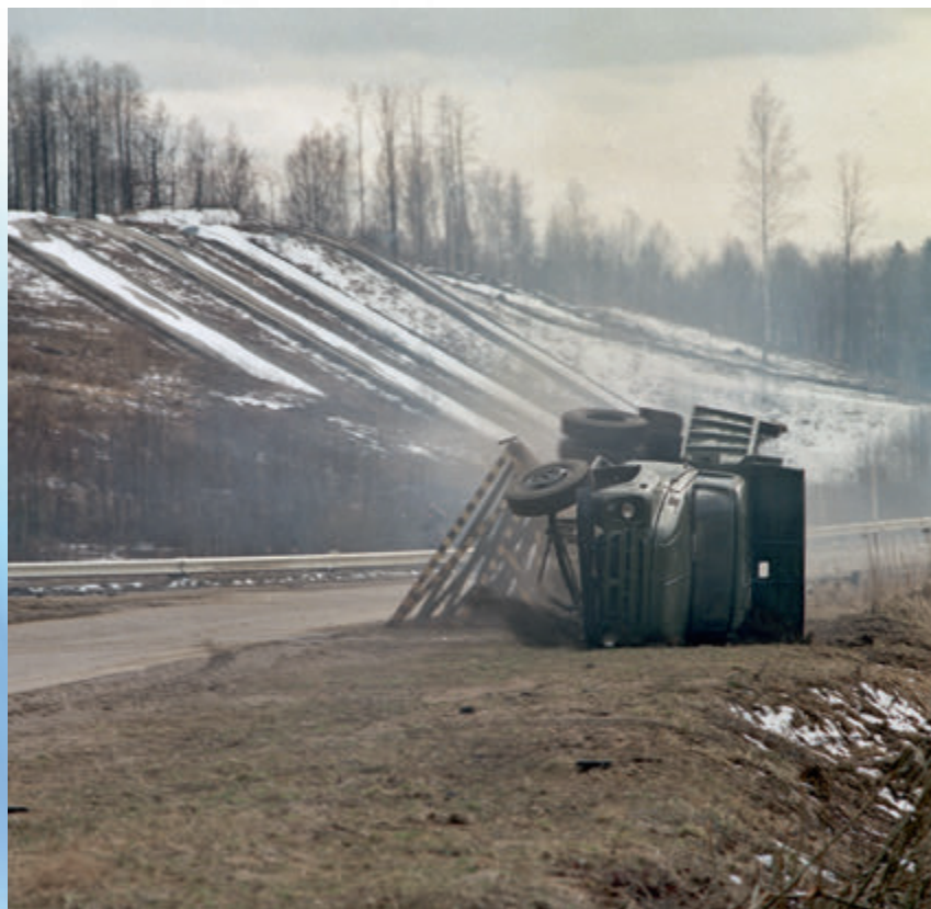
Опрокидывание самосвала ЗИЛ-ММЗ-4502 с помощью трамплина
