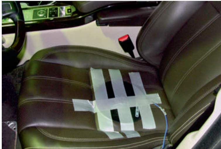
Измерение общей вибрации на сидении водителя
