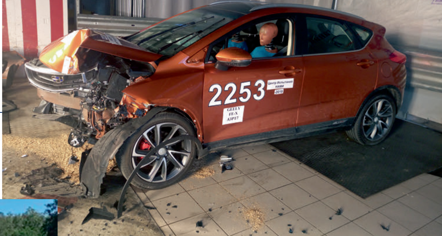
Испытания транспортного средства, оснащенного системой вызова экстренных оперативных служб, в условиях фронтального столкновения
