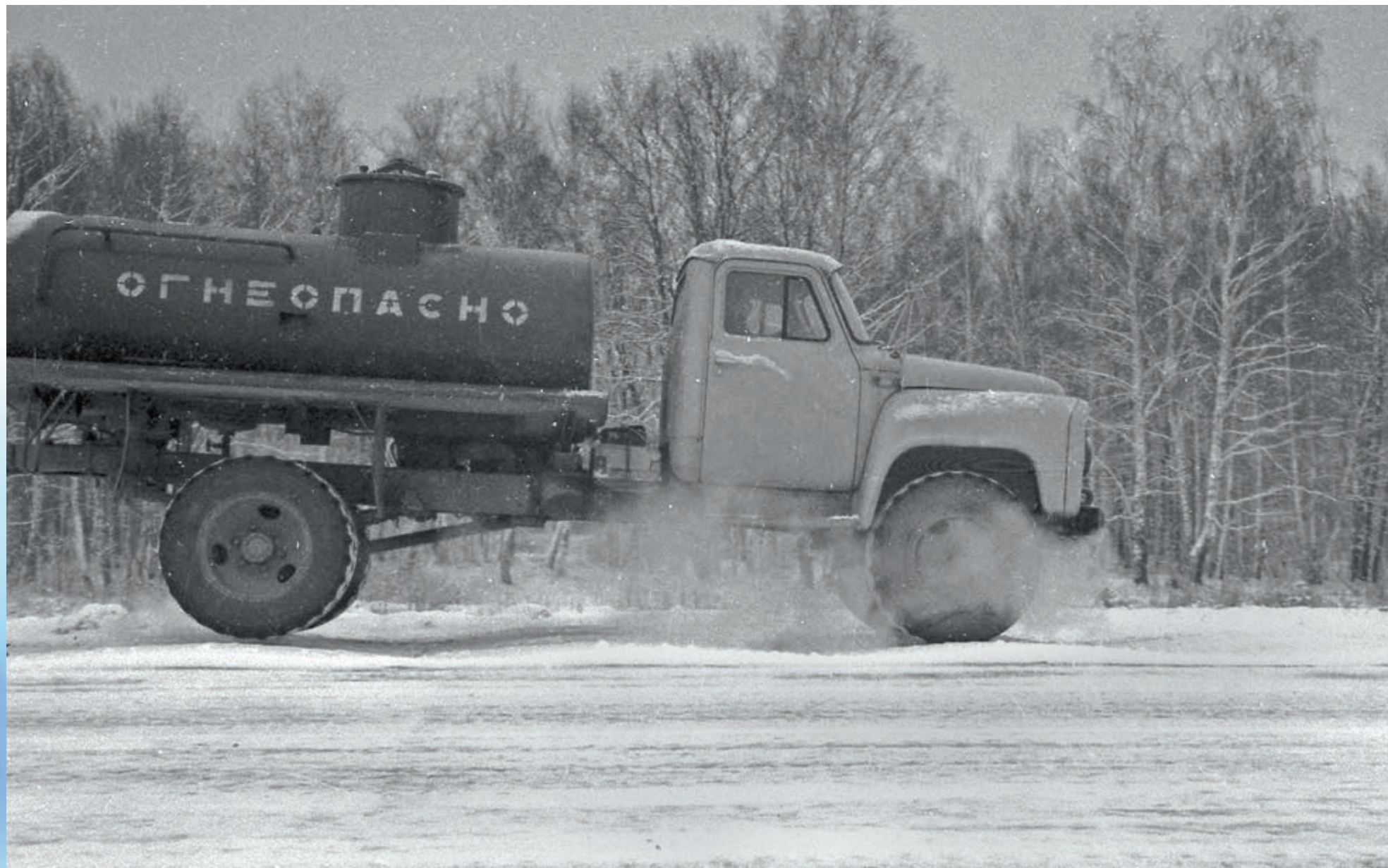
Дорожные испытания бензовоза с целью оценки прочности и долговечности
