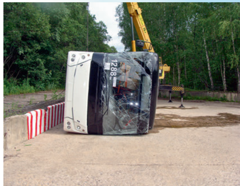
Испытания прочности силовой конструкции автобуса
