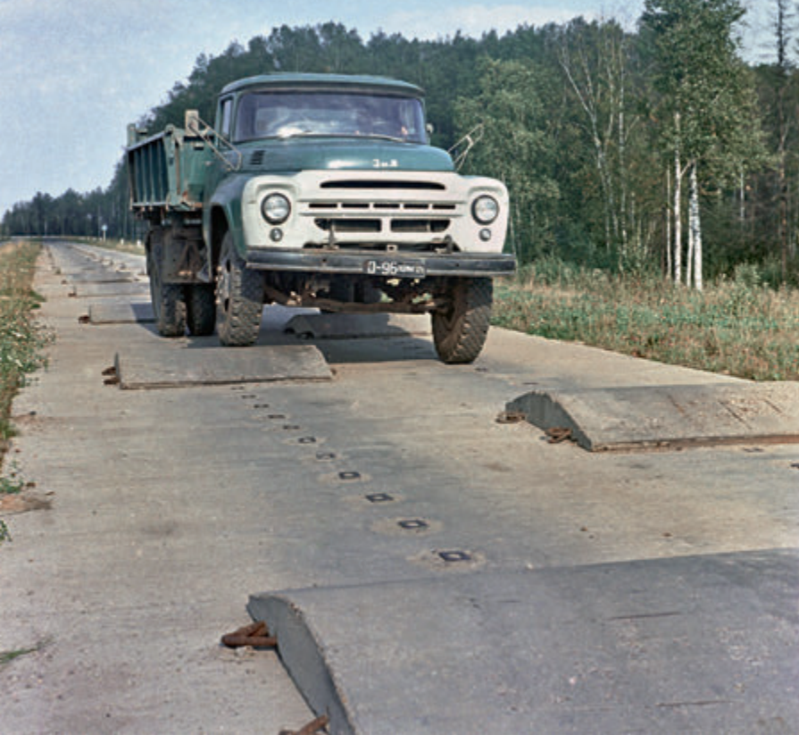
Испытания самосвала ЗИЛ-ММЗ-554 на треке со сменными неровностями
