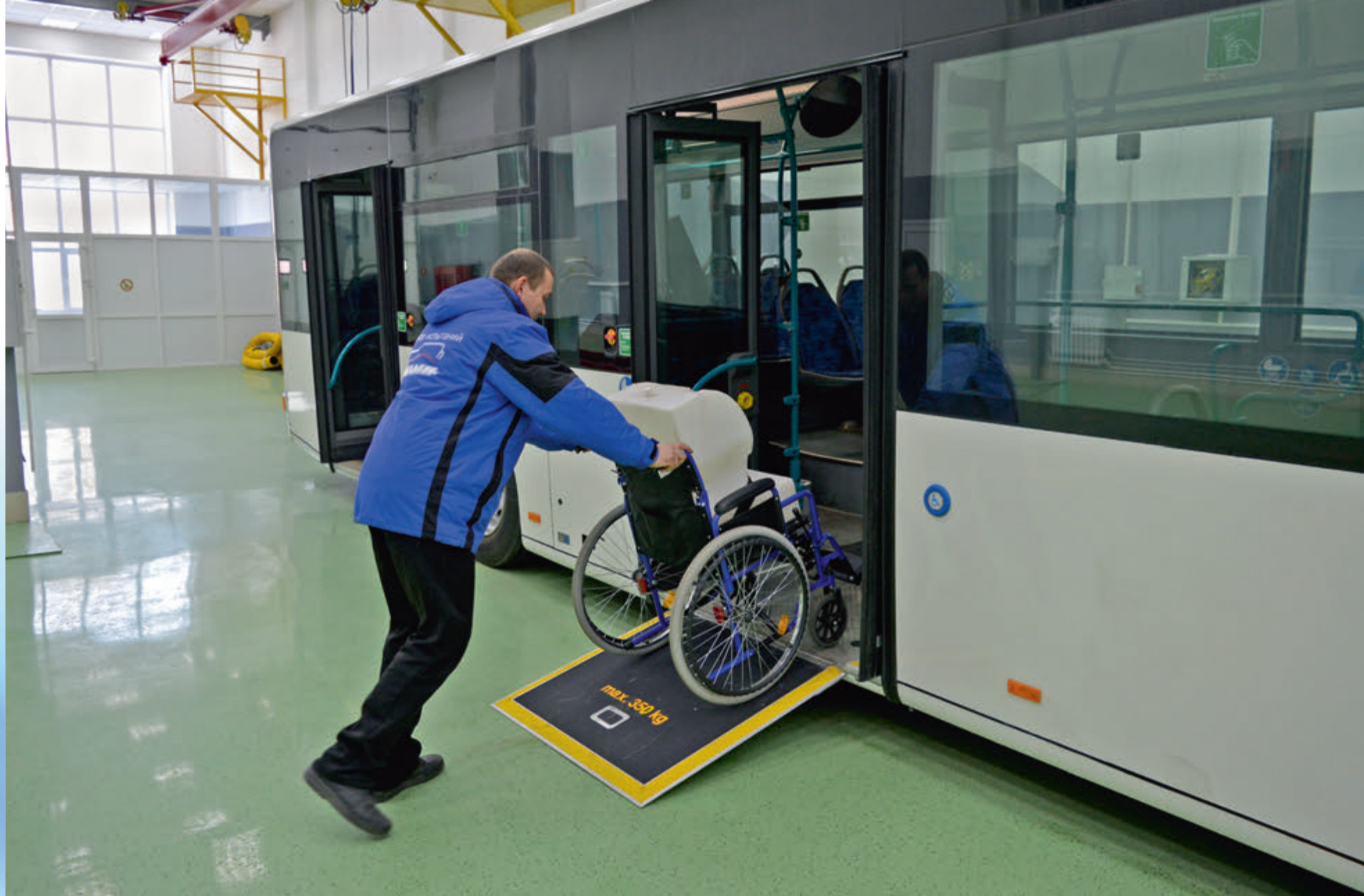
Проверка соответствия автобуса требованиям по безопасной перевозке пассажиров с ограниченной мобильностью
