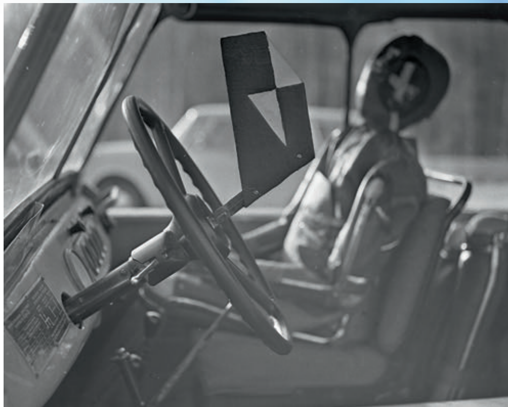
Подготовка автомобиля УАЗ-469 для столкновения с неподвижным препятствием
