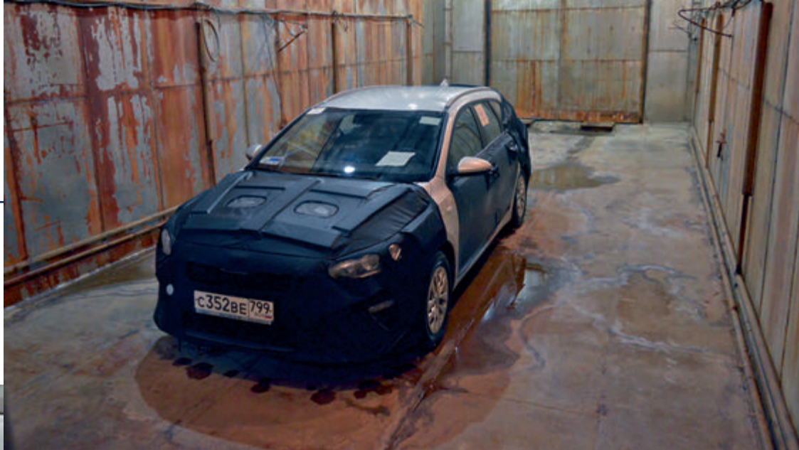
Нанесение искусственных очагов коррозии (ИОК) перед началом испытаний
